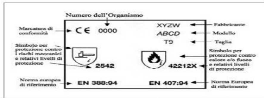
Esempio di marcatura di un guanto di protezione per rischi meccanici e da calore e/o fuoco.
